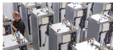
3. Prefabricage van de luchtwaterwarmtepomp (binnenunit). Zie ook afb. 8: schoorsteen met buitenunit.
